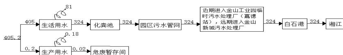
图 4 项目水平衡图 (单位: m 3 /a)
